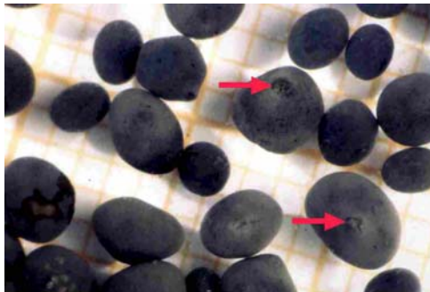
شکل ۲- گرانولهای لجن بی هوازی در UASB
