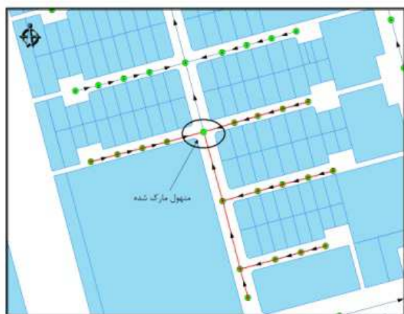
شکل ۹. نشان دادن و انتخاب تمامی خطوط بالادست یک نقطه خاص
