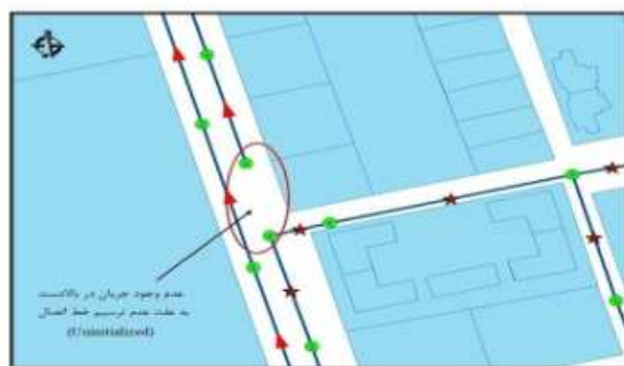
شکل ۶. عدم وجود جریان به سبب عدم ترسیم خط اتصال
